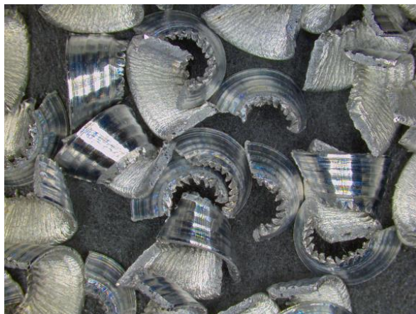
Spanlocken aus AlMg4,5Mn erzeugt mit der CB3.
